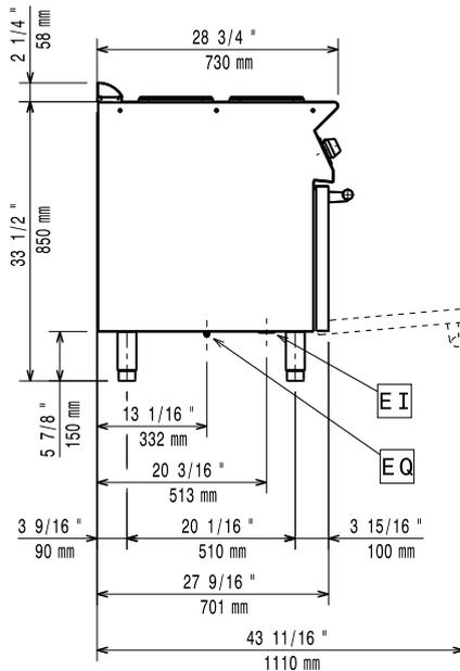
EI = Conexión eléctrica (energía)
